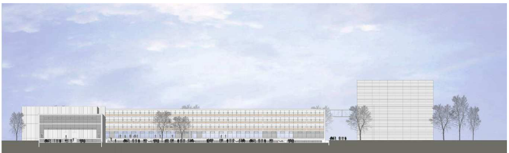
Ansicht des neuen Leibniz-Rechenzentrum aus Norden: Hörsaal/Seminarräume – Mitarbeiter-/Funktionsräume – Brück – Rechnerkubus
