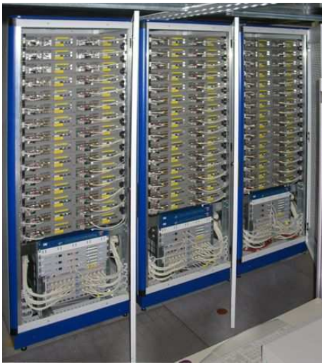
Abbildung 1: Drei MEGWare Racks mit Pentium-4 Knoten
