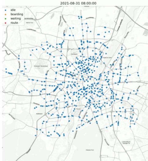
Abbildung 6: Mit der eigenen Open Source Software FleetPy wird die Nutzung von autonomen Shuttles in München simuliert. Grafik: TUM/Lehrstuhl Verkehrstechnik
