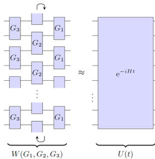
**Abbildung 2:** Approximation des unitären quantenmechanischen Zeitentwicklungsoperators durch einen Quantenschaltkreis, siehe [5] und <https://github.com/qc-tum/rqcopt>. Die Gatter werden auf einem klassischen Rechner mittels Riemannian trust-region-Methoden optimiert.
